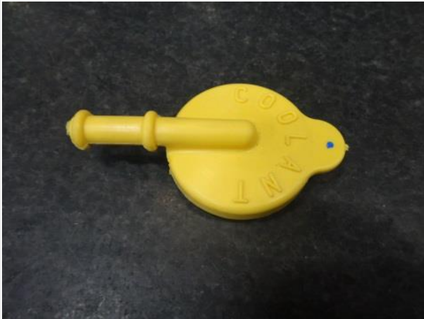
Image 7 : Nouveau bouchon du réservoir de liquide de refroidissement
